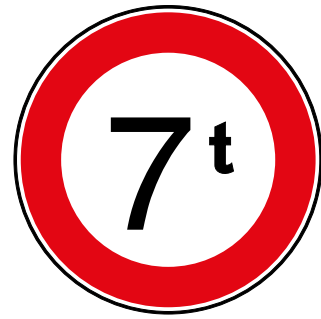
Limitation de tonnage ممنوع مرور الشاحنات التي تزيد حمولتها عن 7 طن Vehicles exceeding the maximum gross weight prohibited Fig. 68
