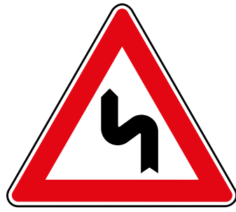
Succession de virages dont le premier est à gauche منعطفات اولها يسار Double bend ahead, the first to the left
