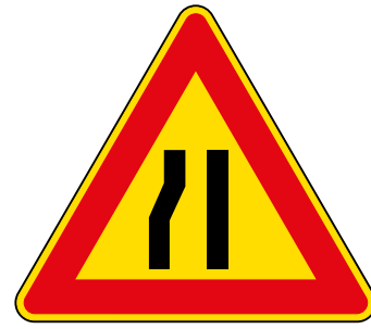
Chaussée rétrécie par la gauche طريق ضيق على اليسار Road narrows on left side ahead
