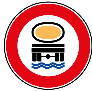
Accès interdit aux véhicules transportant des produits de nature à polluer les eaux ممنوع مرور الآليات المحملة بمواد ملوثة للمياه Vehicles carrying water-polluting material prohibited Fig. 64/B
